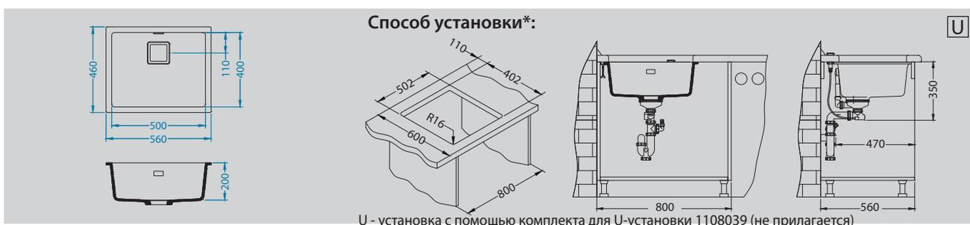
U - установка с помощью комплекта для U-установки 1108039 (не прилагается)
