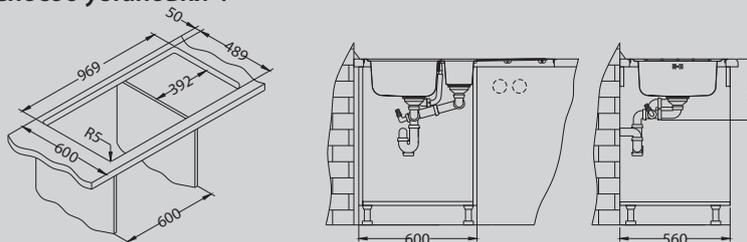
\* Для полностью врезной установки F соответствующий вырез обрабатывается следуя инструкциям
